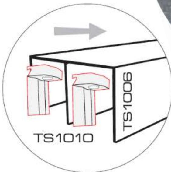
Die Türstopper nach erfolgter Montage der Deckenschiene positionieren und Imbusschraube fest anziehen.
