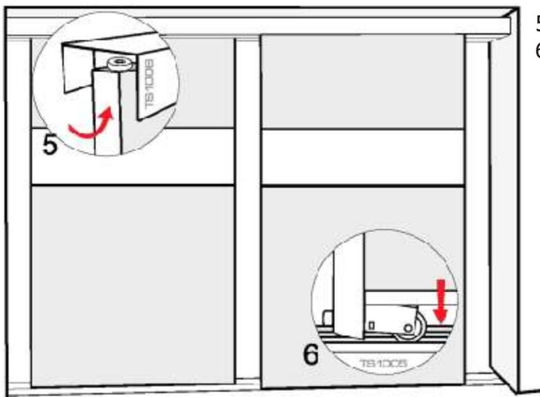
5. Türflügel in Deckenschiene einführen
